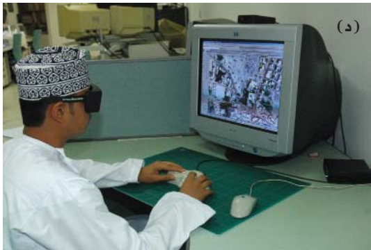
الشكل (١٨) : يوضح بعض أجهزة المسح الجوي التصويري وتطورها من أجهزة تقليدية إلى شبه آلية ومن ثم وحدات التحليل الرقمية.
