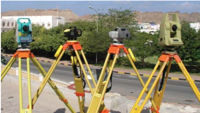
الشكل (٩) : بعض الأجهزة الإلكترونية المستخدمة لحساب المسافات
