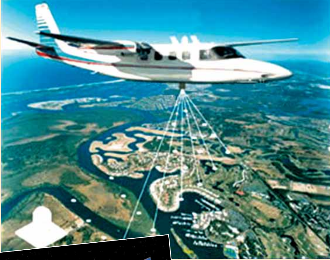
الشكل (١) : طائرة تلتقط صوراً متتابعة لسطح الأرض مدعومة بالإحداثيات .
