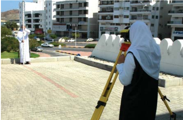
الشكل (٨) : جهاز الميزان والقامة المدرجة التي يحسب بها الارتفاع
