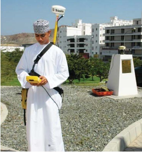
الشكل (١٤) : الطريقة التفاضلية في تحديد المواقع ويظهر جهاز الاستقبال الثابت والجهاز المحمول المتحرك
