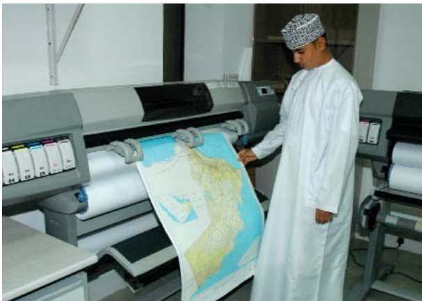
الشكل (٣٥) : الراسمة الآلية (Plotter) وهي ترسم خريطة السلطنة
